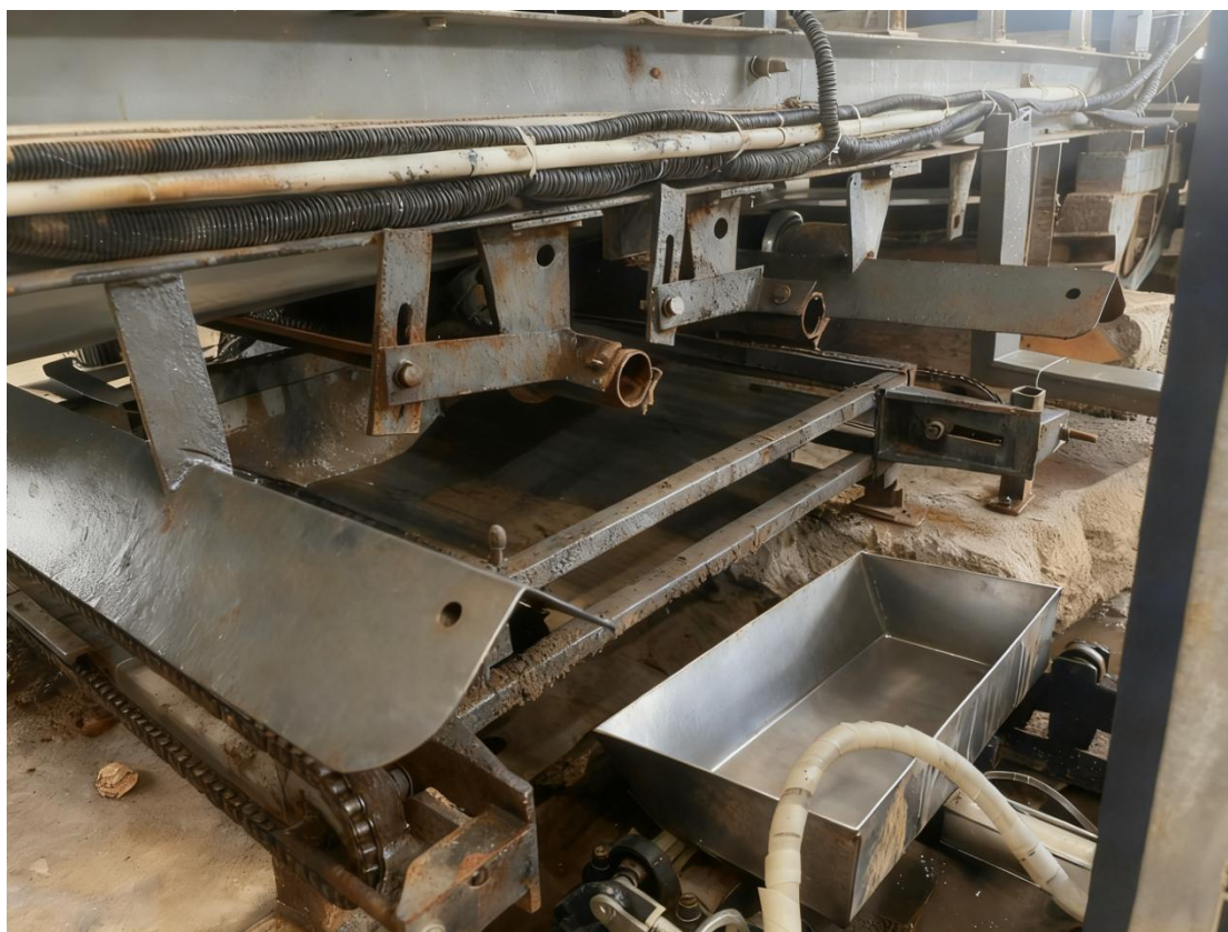
图 7.1 皮带机自动清扫装置（企业自行改良）
